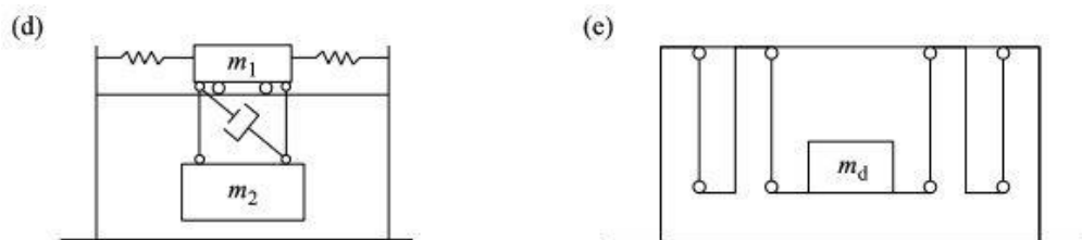
Figura 12. Clasificación típica de TMD; d) amortiguador de dos masas, e) amortiguadores multi etapas
