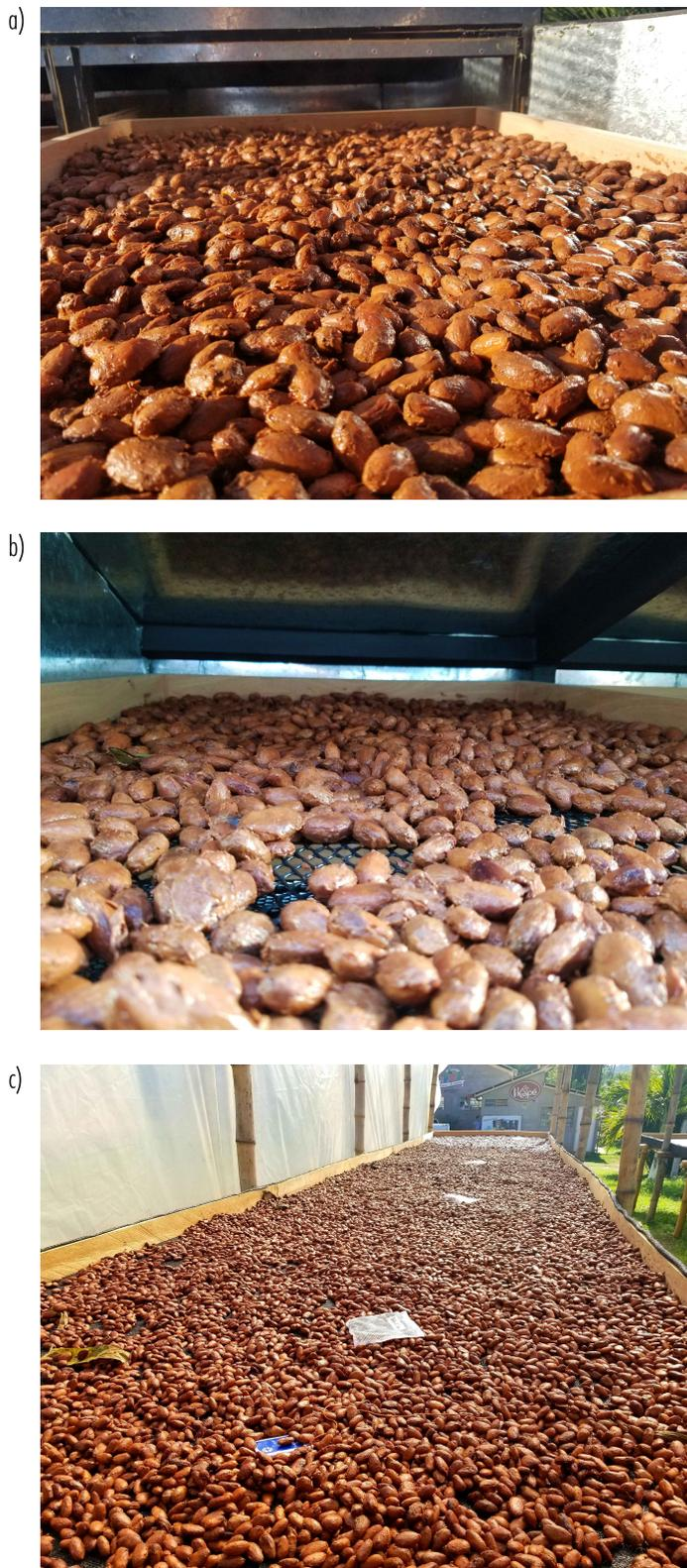
**Figura 3.** Carga de cacao en los secadores: a) secado solar alternativo 25 lbs por bandeja, b) secado de 17 lbs por bandeja y c) secado convencional.
