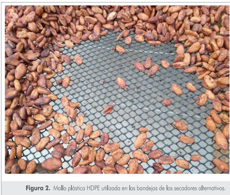
Figura 2. Malla plástica HDPE utilizada en las bandejas de los secadores alternativos.
