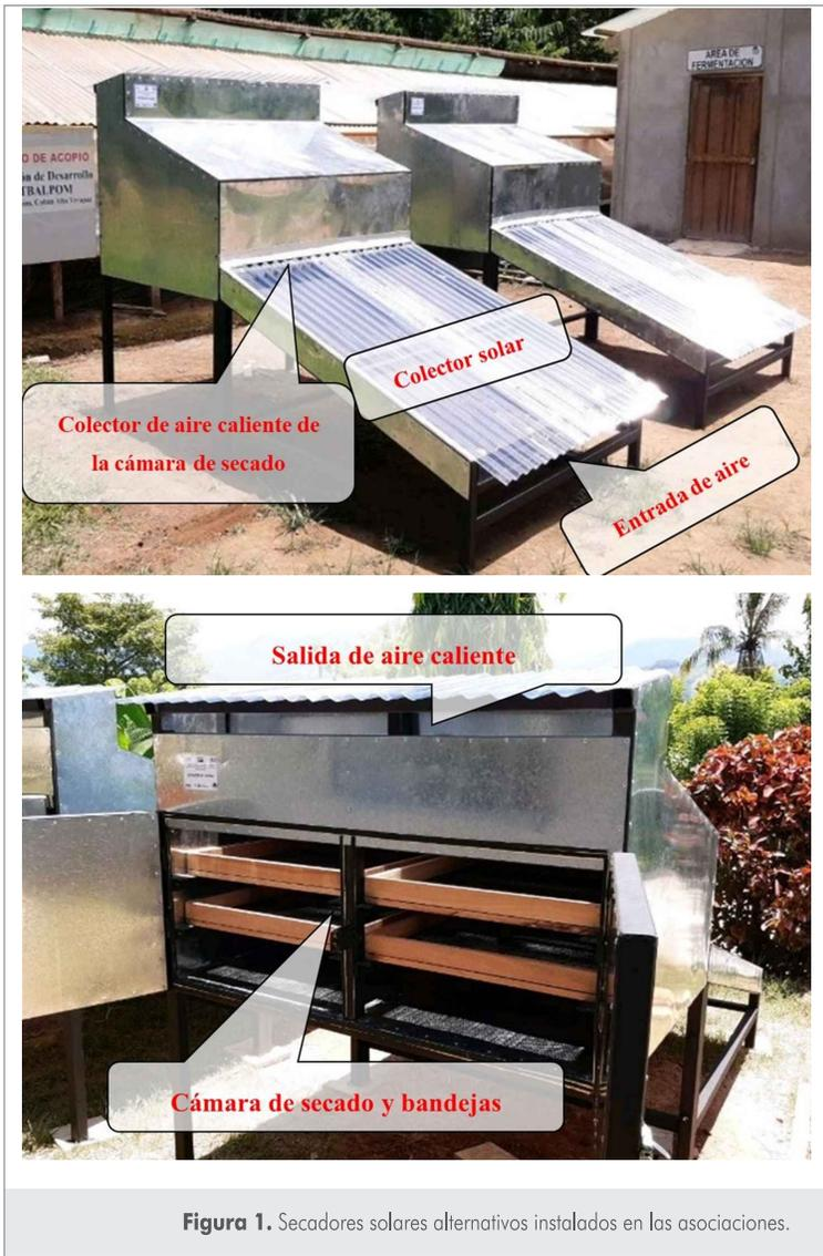
Figura 1. Secadores solares alternativos instalados en las asociaciones.
