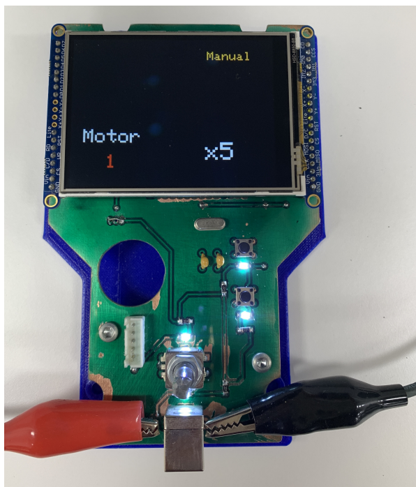
Figura 44: PCB fabricada montada sobre la tapadera mostrando su funcionamiento con la iluminación y los datos mostrados en pantalla
