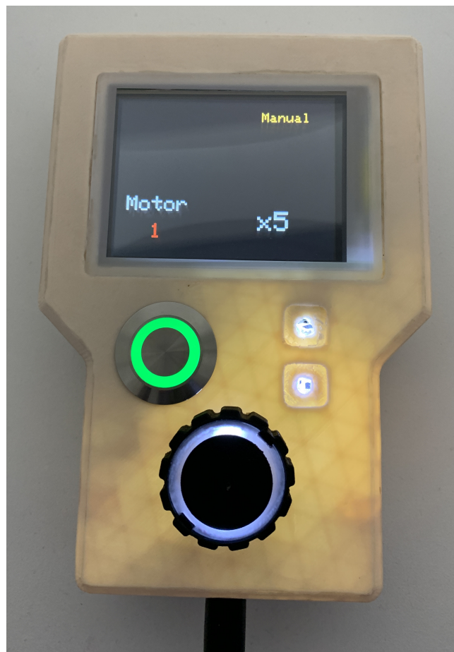
Figura 41: Vista superior del control remoto ensamblado y funcionando con sus luces decorativas.
