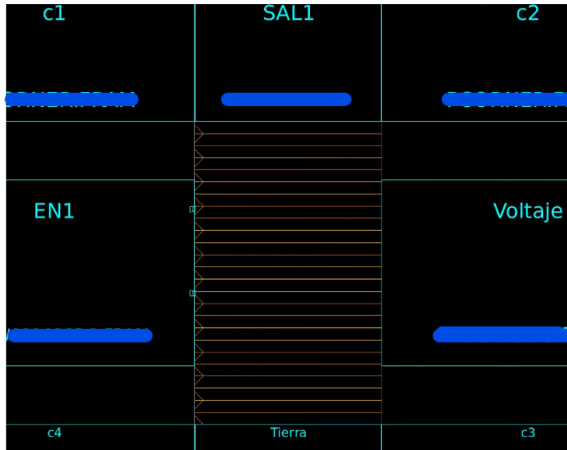
Figura 29: Floorplan con Rows por defecto
