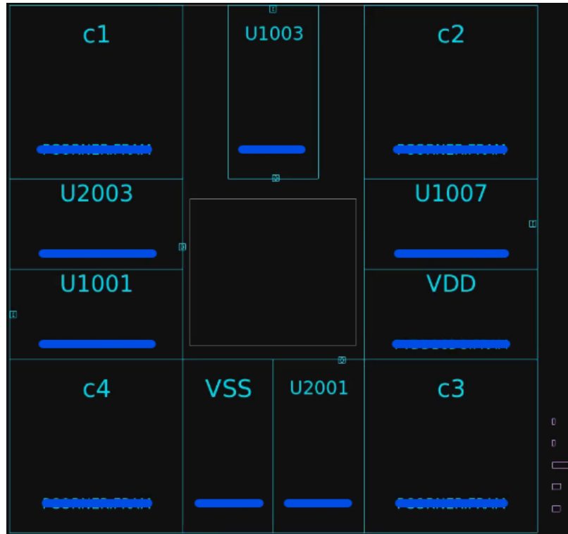
Figura 23: Creación de Floorplan por defecto, circuito Full Adder .
