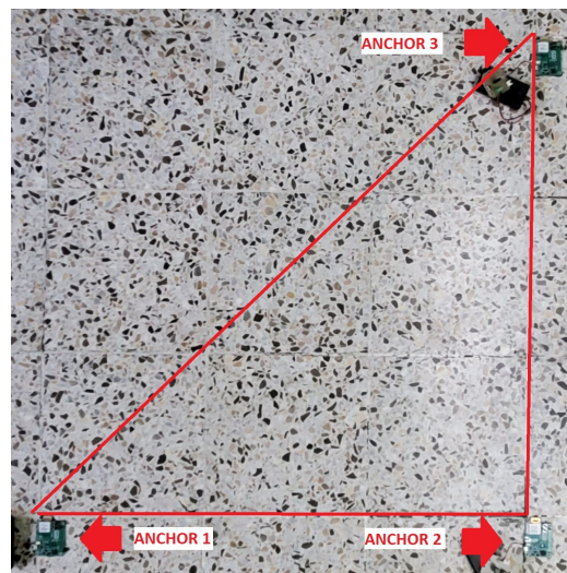
Figura 23: Configuración física de prueba de los DWM1001 como anchor
