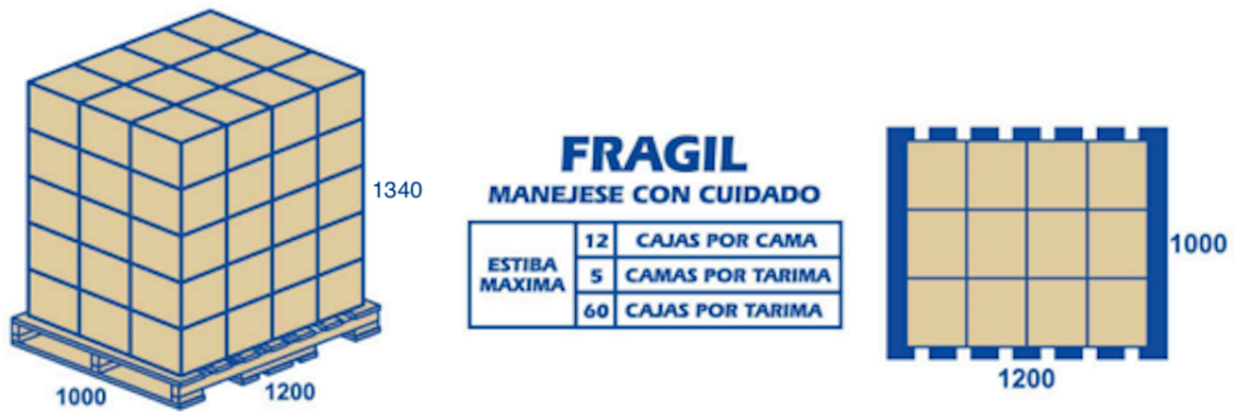
Figura 56- Estibado de cajas de producto terminado
