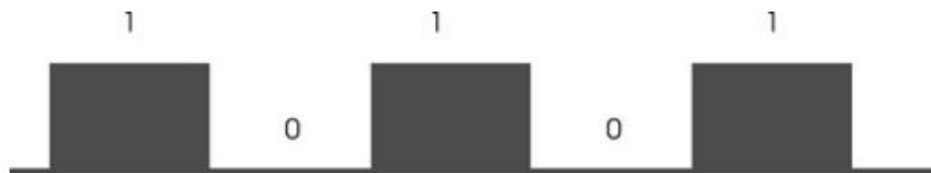
Figura 4: Señal que emite un encoder [11].
