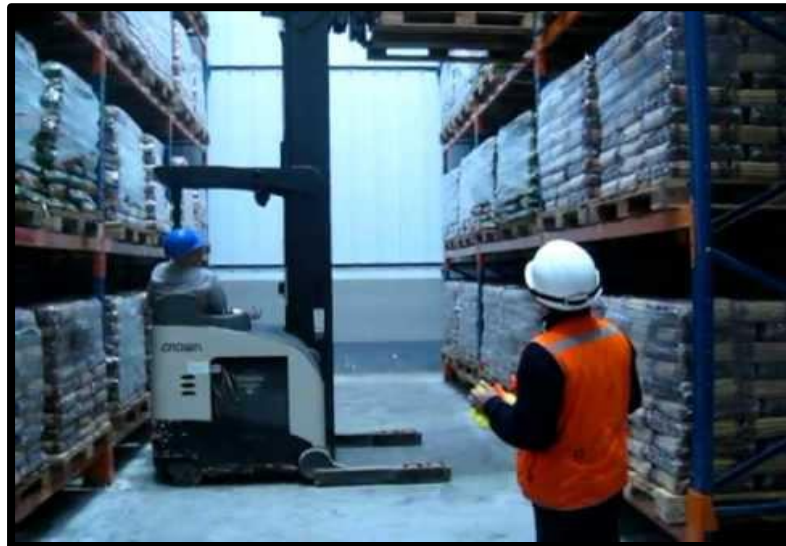
Gráfica 12: Se muestran los tipos de montacargas que se utilizan en bodega de Guatemala y El Salvador, montacargas de operador parado para almacenaje de producto en estanterías y montacargas de operador sentado para la descarga y manipulación de producto.
