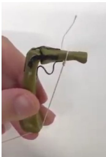
Figura 72: Articulación PIP unida con pegamento de contacto sometida a flexión
