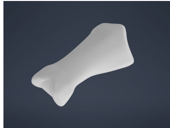
Figura 33: Segunda falange media moldeada con la herramienta Freeforms de Autodesk Inventor.
