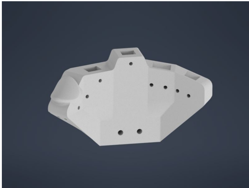
Figura 69: Segunda iteración del carpo diseñado en Autodesk Inventor.
