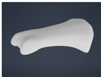
Figura 49: Quinta falange proximal moldeada con la herramienta Freeforms de Autodesk Inventor.
