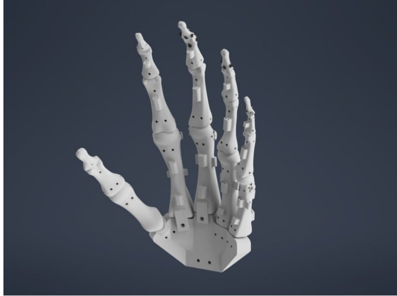
Figura 70: Ensamble completo del sistema óseo de la mano.
