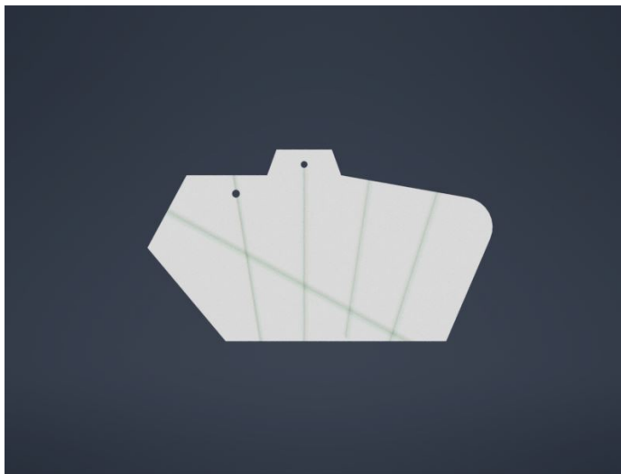
Figura 63: Vista frontal de la base diseñada en Inventor. Se pueden ver los planos con los ángulos para la posición de cada dedo.
