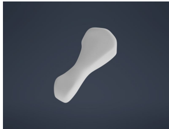
Figura 47: Quinta falange distal moldeada con la herramienta Freeforms de Autodesk Inventor.
