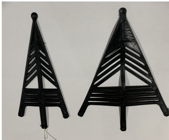
Figura 91: Aparato dorsal del dedo índice. Primera iteración (izquierda) y segunda iteración (derecha).
