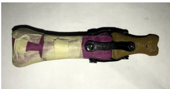
Figura 74: Articulación PIP unida con tornillos. Vista dorsal.
