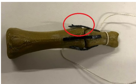
Figura 73: Articulación PIP unida con pegamento de contacto. Ligamento colateral luego de 64 iteraciones de flexión-extensión.
