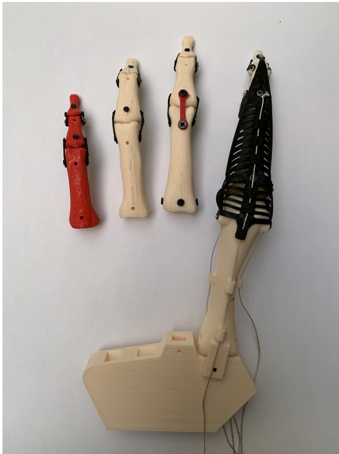
Figura 124: Ensamble del dedo índice a la base y de los otros 3 dedos.
