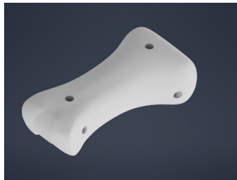
Figura 55: Primera falange proximal moldeada con la herramienta Freeforms de Autodesk Inventor.
