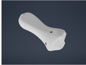
Figura 54: Primera falange distal moldeada con la herramienta Freeforms de Autodesk Inventor.
