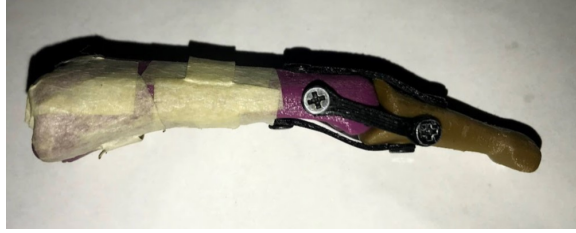
Figura 75: Articulación PIP unida con tornillos. Vista radial.
