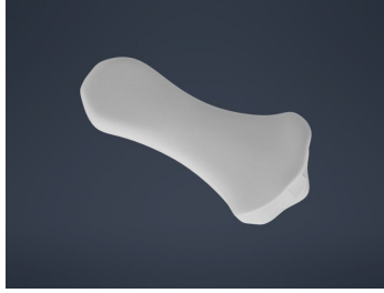
Figura 42: Cuarta falange distal moldeada con la herramienta Freeforms de Autodesk Inventor.
