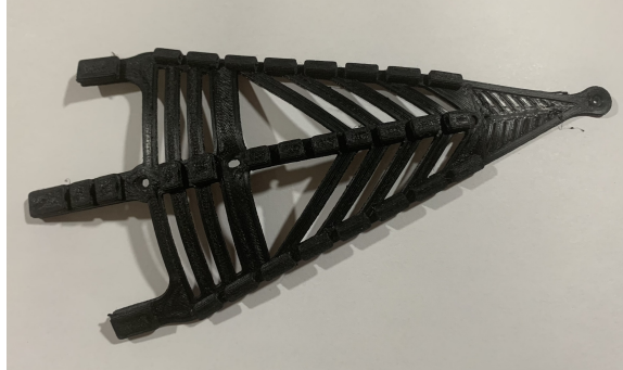
Figura 92: Expansión del extensor, iteración 3. En las bandas laterales y tendón central posee canales para los hilos.
