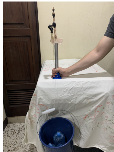
Figura 137: Ensayo de peso para FDS.
