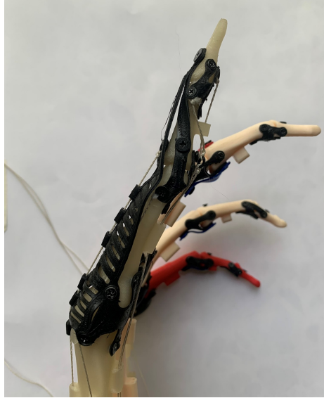
Figura 78: Movimiento de extensión en el dedo índice con hiperextensión en la articulación PIP.
