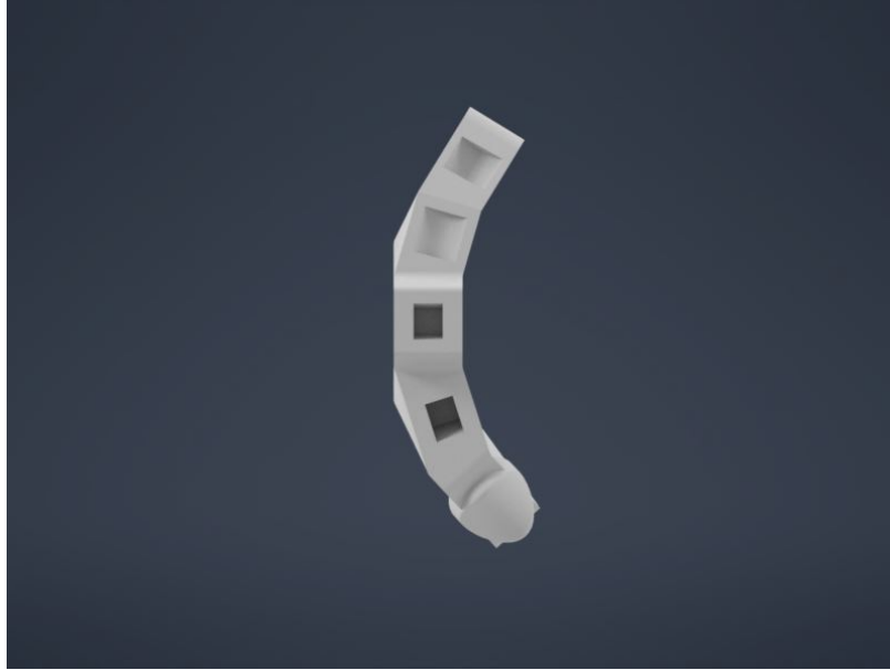
Figura 68: Vista desde arriba del carpo diseñado en Autodesk Inventor.
