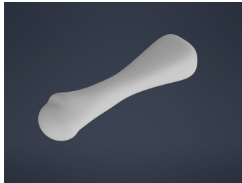
Figura 40: Tercer metacarpiano moldeado con la herramienta Freeforms de Autodesk Inventor.
