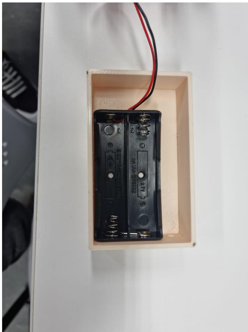
Figura 23: Nuevo compartimento para baterías y módulo de radiofrecuencia
