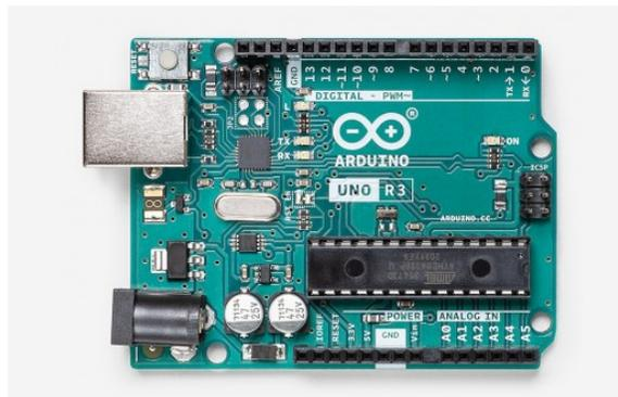
Figura 4: Arduino UNO R3.0 utilizando un microcontrolador ATmega328P
