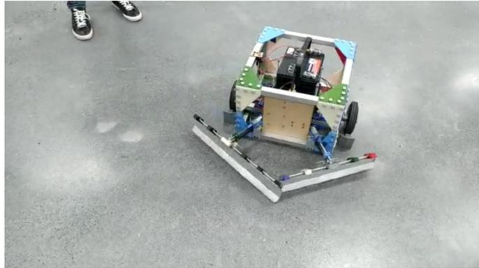
Figura 75: Prueba de movimiento de robot principal dentro de laboratorio
