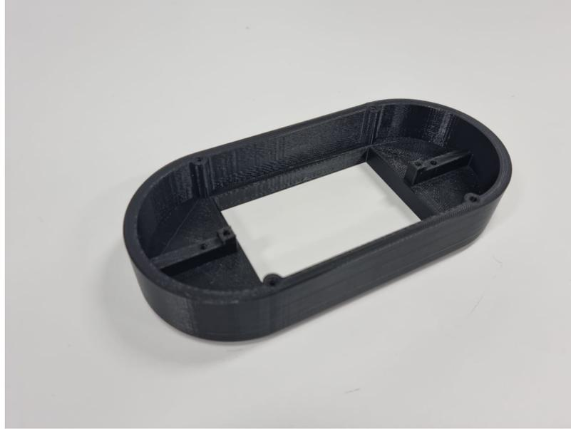
Figura 47: Cuerpo principal fabricado para prototipo No.2 de control remoto
