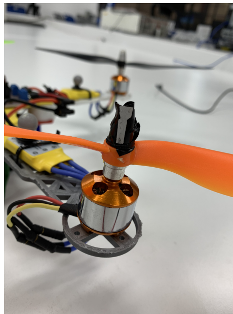
Figura 10: Colocación de cinta reflectiva para la medición con tacómetro.
