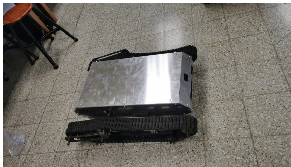
Figura 42: Estructura completamente armada
