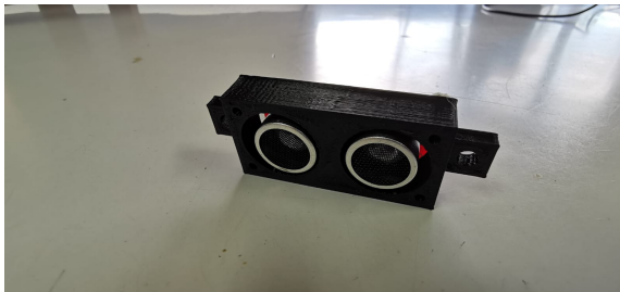
Figura 44: Preparación de sensores ultrasónicos, vista frontal
