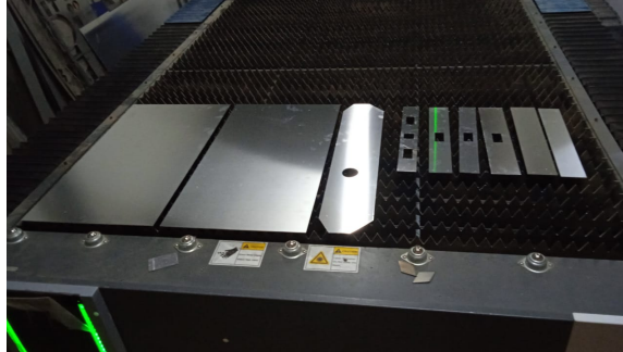
Figura 37: Placas cortadas con CNC durante la fabricación
