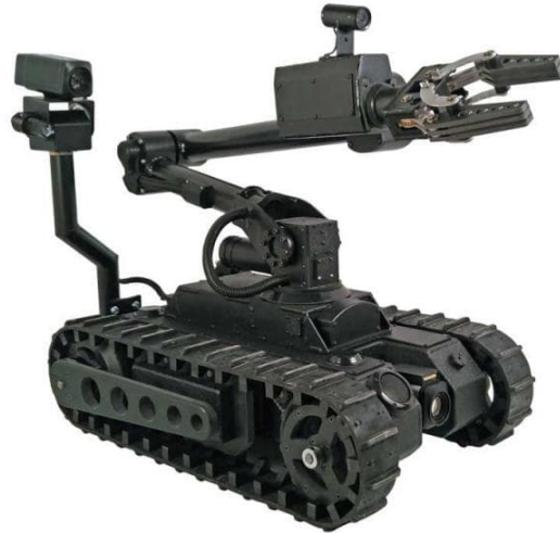
Figura 4: Robot explorador con sistema de oruga, brazo mecánico y cámaras [7]
