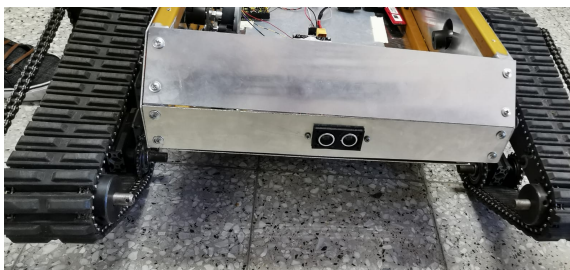
Figura 46: Vista trasera con sensor instalado
