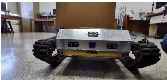
Figura 45: Vista frontal con sensores y cámara instalada
