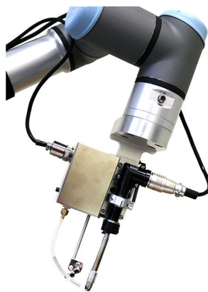
(a) Efecter final de soldadura [9].
