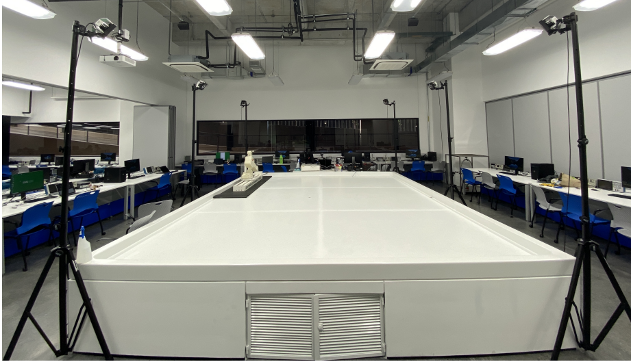
Figura 21: Montaje del sistema OptiTrack.
