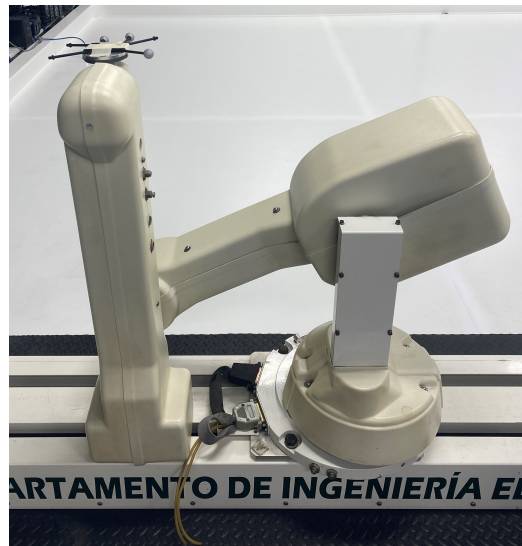
Figura 22: Cuerpo rígido en efector final del R17.
