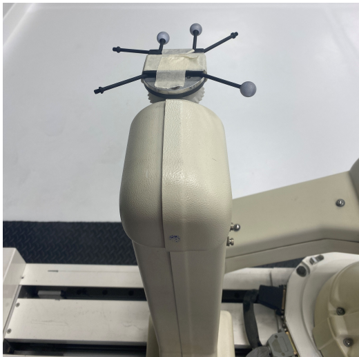
Figura 22: Cuerpo rígido en efector final del R17.
