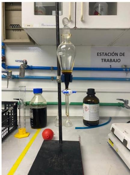
**Figura 64. Separación de fases líquidas en equilibrio en embudo de decantación**
