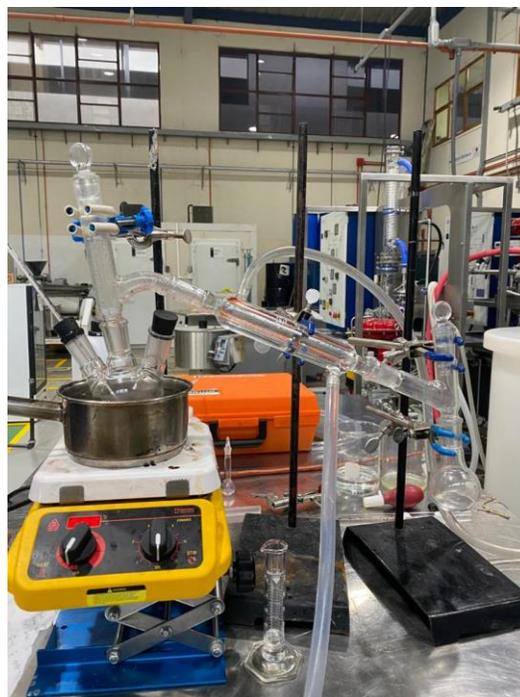
**Figura 65. Sistema experimental de destilación simple de acetato de etilo**
