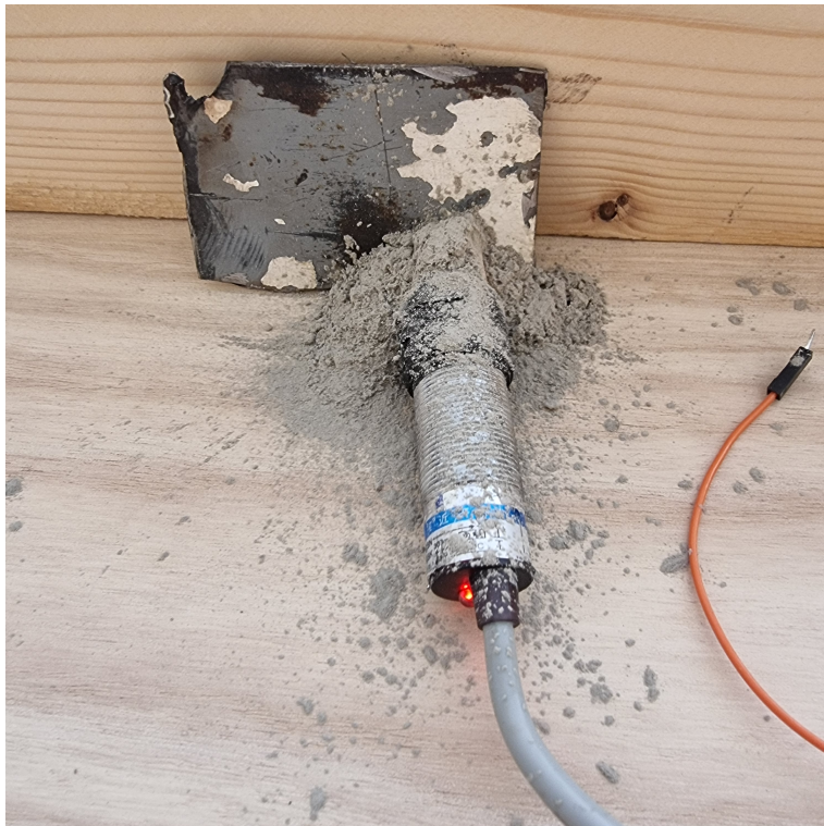
Figura 13: Sensor inductivo con polvillo
