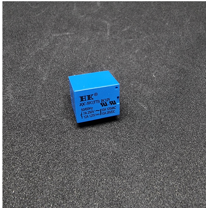
Figura 30: Relé JQC-3FC(T73) utilizado
