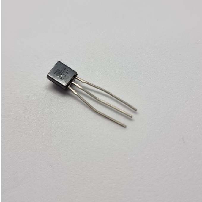
Figura 31: Transistor 2n3904 utilizado
