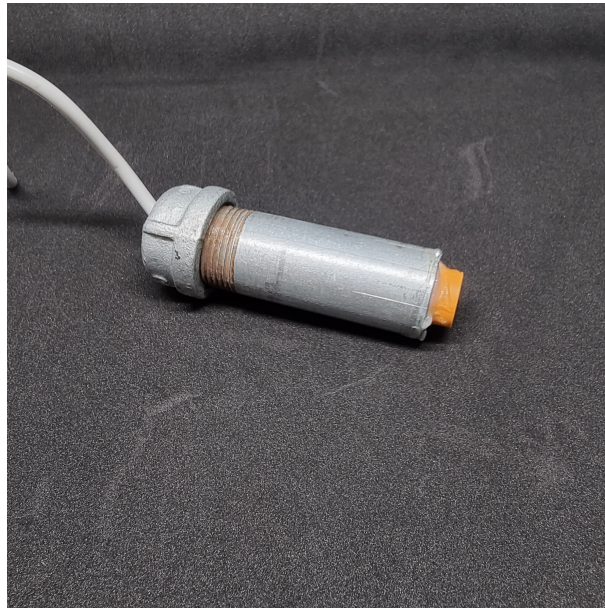
Figura 16: Sensor de proximidad inductivo cubierto con niple de acero
