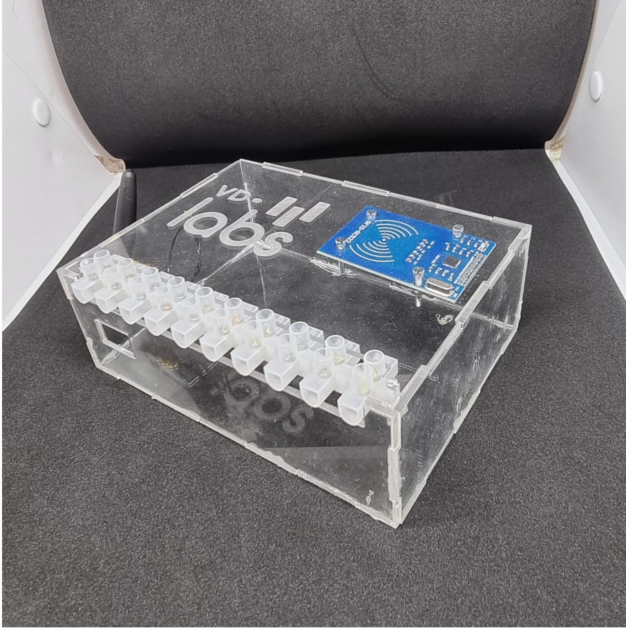
Figura 39: Caja sin PCB y sin switch
