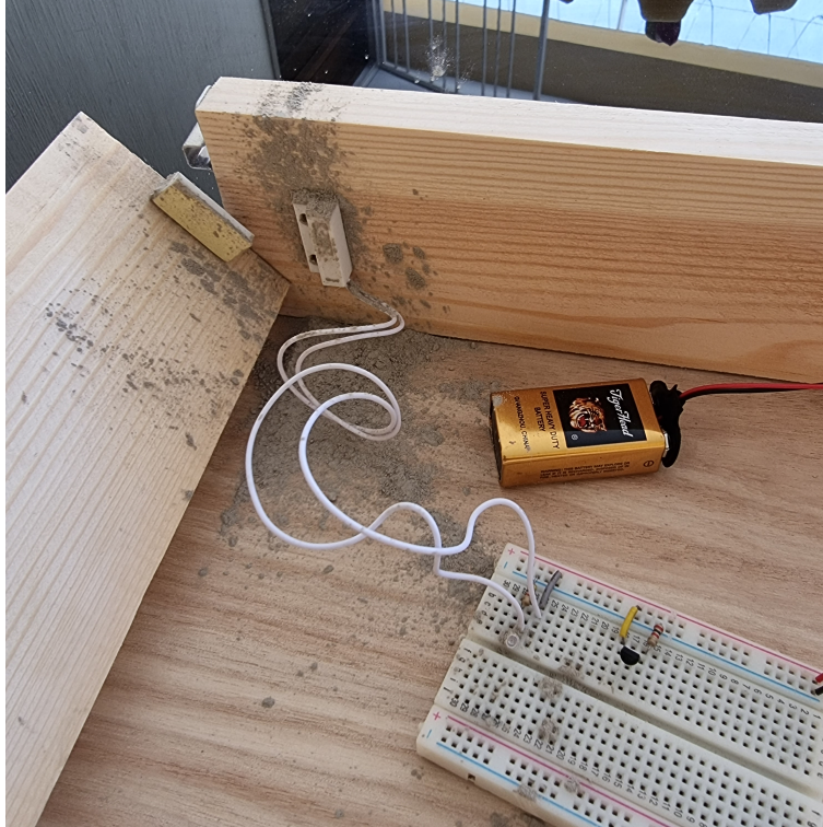
Figura 10: Switch magnético con polvillo puerta abierta
