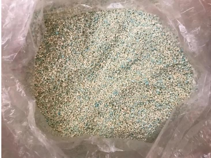
**Figura 33.** 10 kilogramo de nitrato de amonio recubierto de adherente A con mezcla de 477 gramos de micronutrientes.
