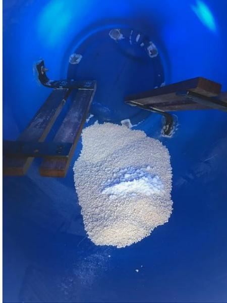
**Figura 29.** Adición de 30 gramos del compuesto de sulfato de cinc a 1 kilogramo de nitrato de amonio.
