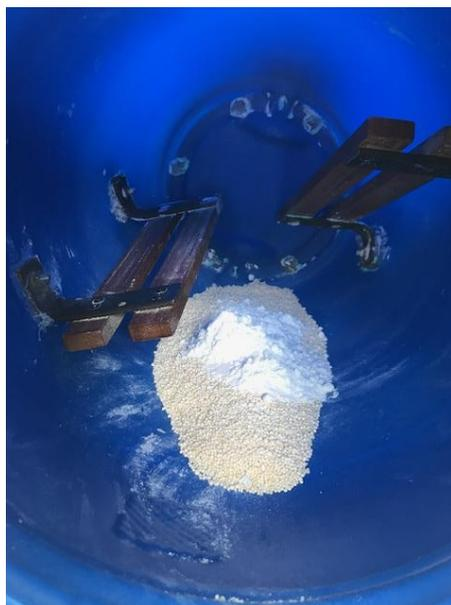
**Figura 22.** Adición de 60 gramos del compuesto de octoborato de sodio a 1 kilogramo de nitrato de amonio.
