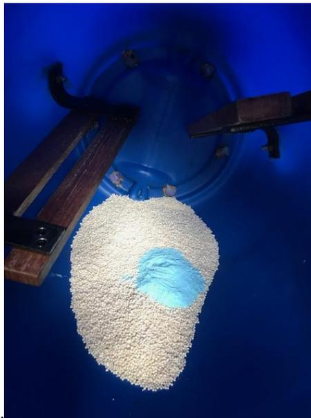
**Figura 24.** Adición de 30 gramos del compuesto de sulfato de cobre a 1 kilogramo de nitrato de amonio.
