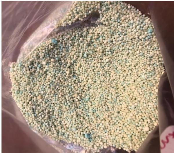
**Figura 32.** Kilogramo de nitrato de amonio recubierto de adherente C con mezcla de 60 gramos de micronutrientes.
