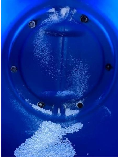
**Figura 27.** Polvo no adherido de sulfato de manganeso al nitrato de amonio en el fondo de la mezcladora.
