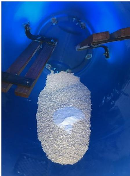
**Figura 26.** Adición de 30 gramos del compuesto de sulfato de manganeso a 1 kilogramo de nitrato de amonio.
