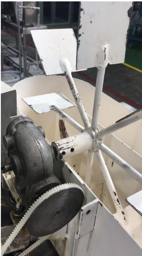
Figura 23. Motor utilizado para el funcionamiento del sistema de agitación del reactor
