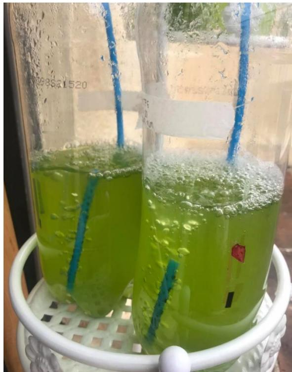
Figura 37. Apariencia de los cultivos colocados en los reactores a pequeña escala (1L) al finalizar el experimento de la variación de la intensidad luminosa
