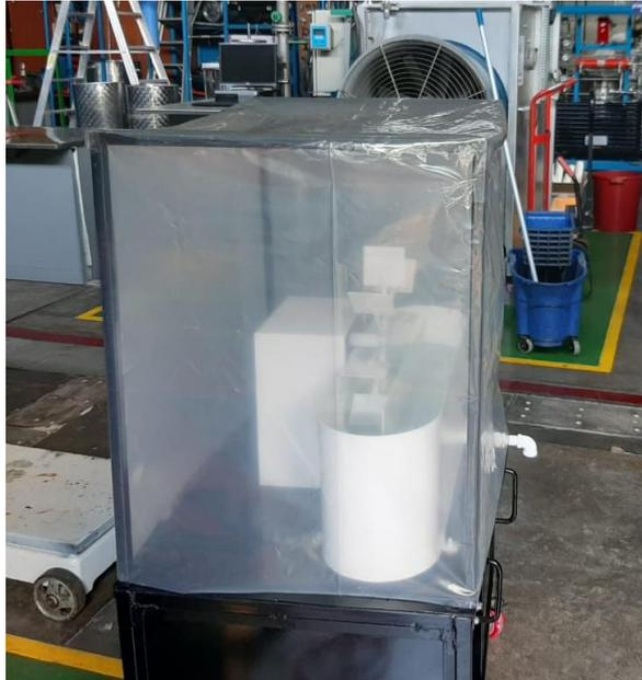
Figura 28. Prueba del sistema de aireación del reactor con piedras difusoras
