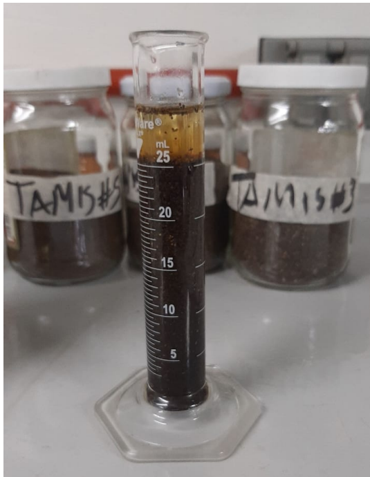
Figura 52. Prueba de expansión de la bioresina fabricada.
