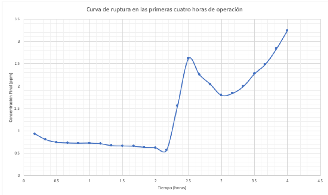
Figura 27. Curva de ruptura del agua contaminada con 20ppm de Plomo II, luego que abandona el lecho, considerando solo los tiempos de contacto de las primeras cuatro horas.
