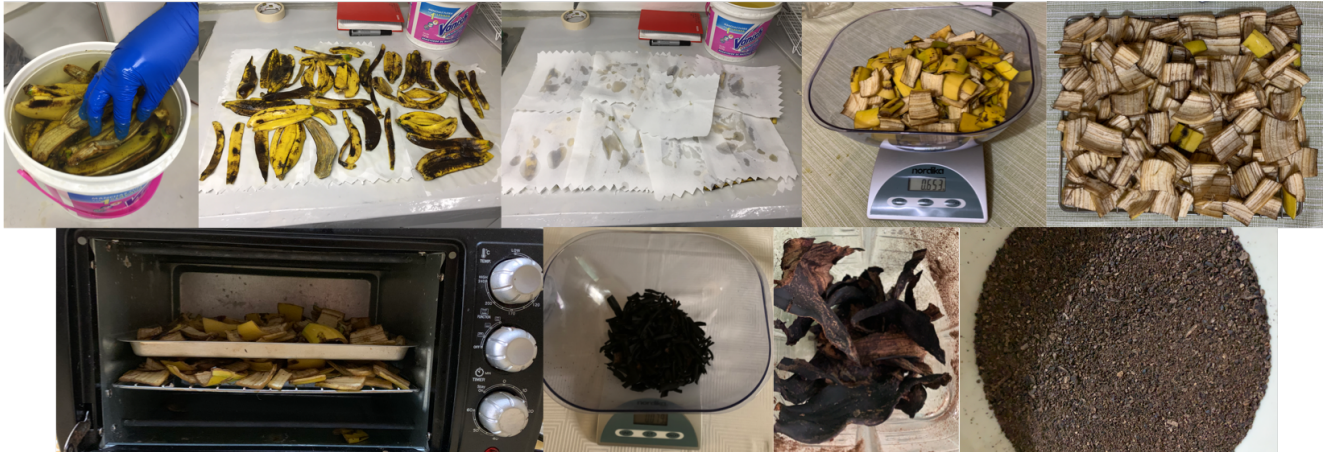
Figura 48. Tratamiento de lavado, secado y de reducción de tamaño a la cáscara de banano para su posterior uso como adsorbente natural.
