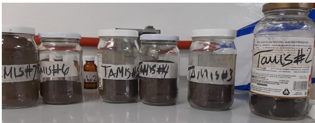
Figura 50. Bioresina fabricada separada por tamaño de partícula.
