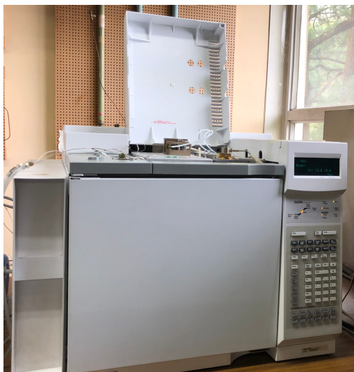
Figura 42. Cromatógrafo de gases con detector de ionización de llama ubicado en el laboratorio de análisis instrumental avanzado del departamento de química en la Universidad del Valle de Guatemala.
