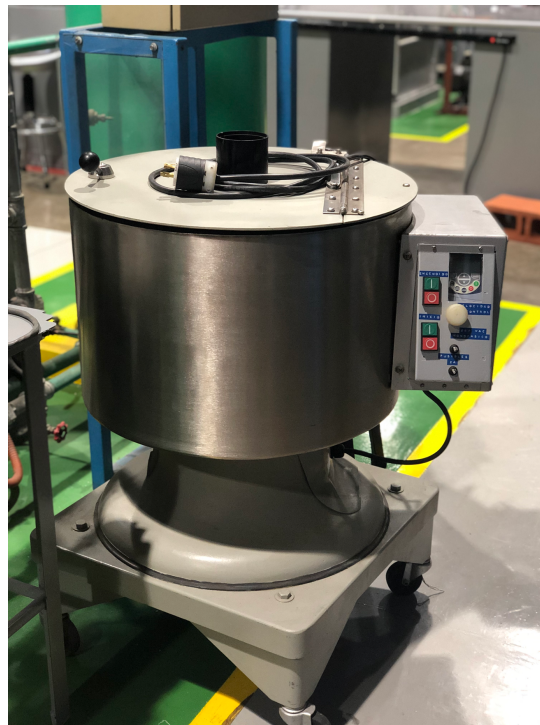
Figura 56. Centrifuga de 8 tubos ubicada en el Laboratorio de Operaciones Unitarias del departamento de ingeniería química de la Universidad del Valle de Guatemala
