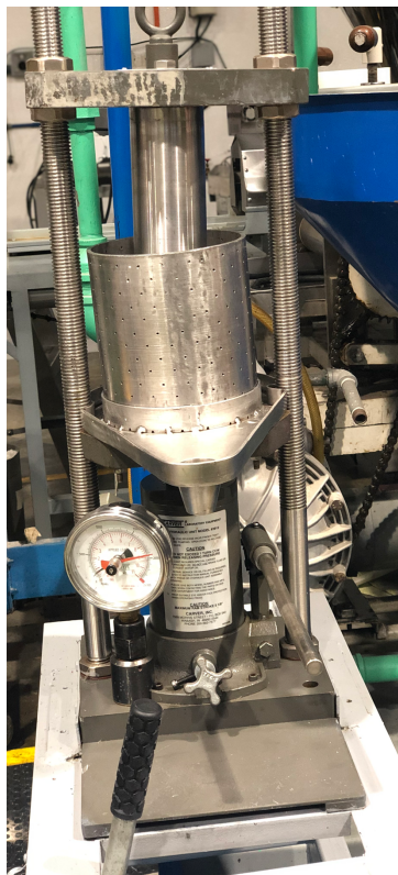
Figura 45. Prensa hidráulica utilizada en el proceso de obtención de jugo de los frutos rojos ubicada en el Laboratorio de Operaciones Unitarias del departamento de ingeniería química en la Universidad del Valle de Guatemala
