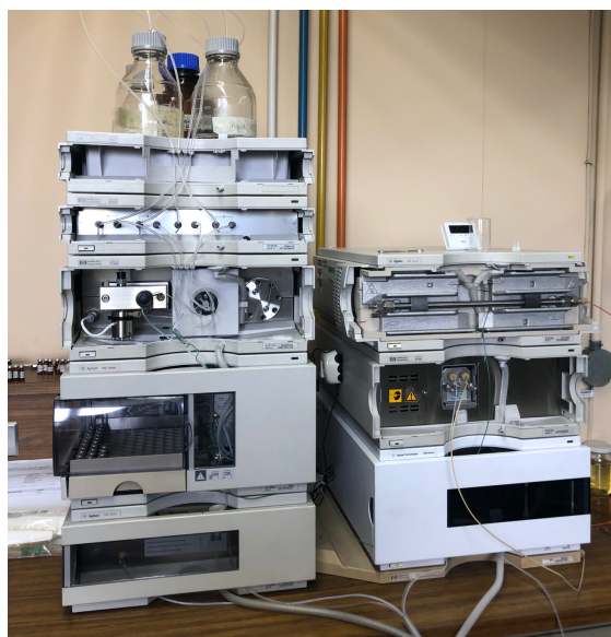
Figura 41. Cromatógrafo HPLC utilizando columna Hi Plex Ca 300X7.08mm ubicado en el laboratorio de análisis instrumental avanzado del departamento de química de la Universidad del Valle de Guatemala
