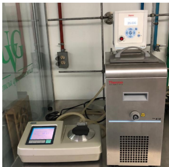
Figura 47. Refractómetro con baño térmico ubicado en el Laboratorio de Operaciones Unitarias del departamento de ingeniería química de la Universidad del Valle de Guatemala
