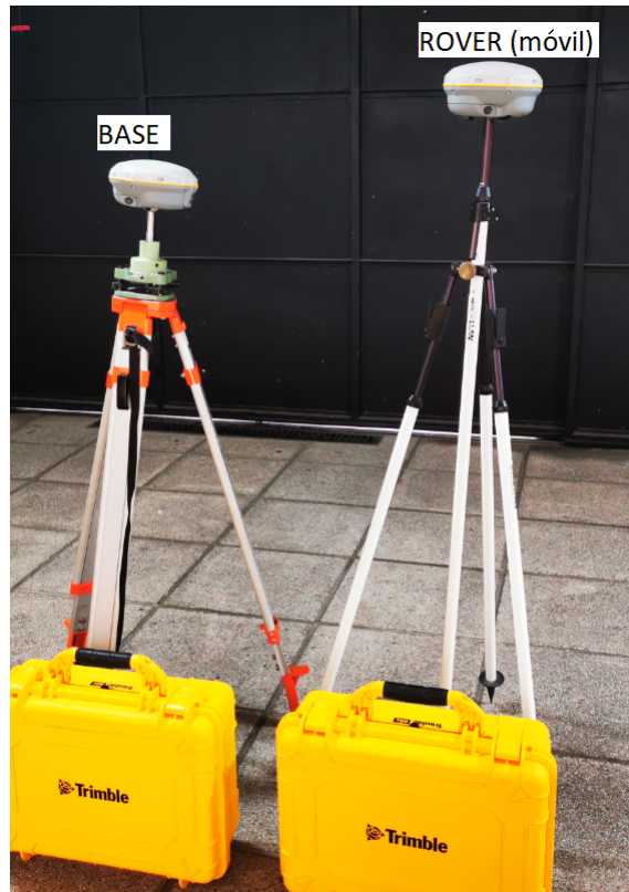
Figura 31: Estación base y estación rover (Fuente: Elaboración propia)
