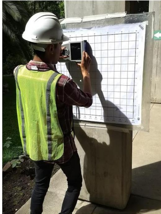
*Figura 27 – Evaluación del acero de refuerzo en las vigas*
