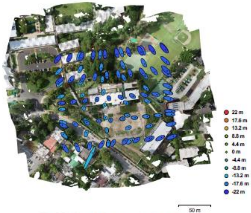
Fig. 3. Posiciones de cámaras y estimaciones de errores. El color indica el error en Z mientras el tamaño y forma de la elipse representan el error en XY. Posiciones estimadas de las cámaras se indican con los puntos negros.
