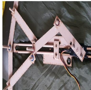
Figura 32: Prototipo mecanismo de extensión
