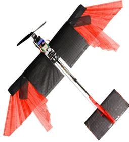
Figura 7: avión no tripulado con alas plegadas inspiradas en aves [5]
