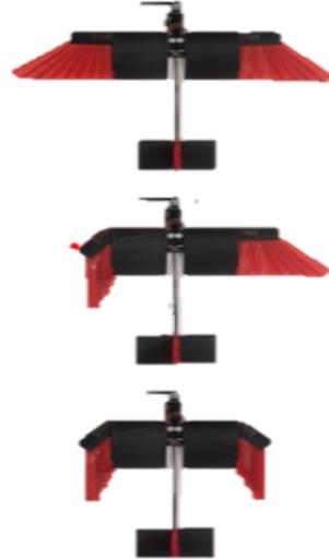
Figura 8: Posiciones de las alas del prototipo [5]
