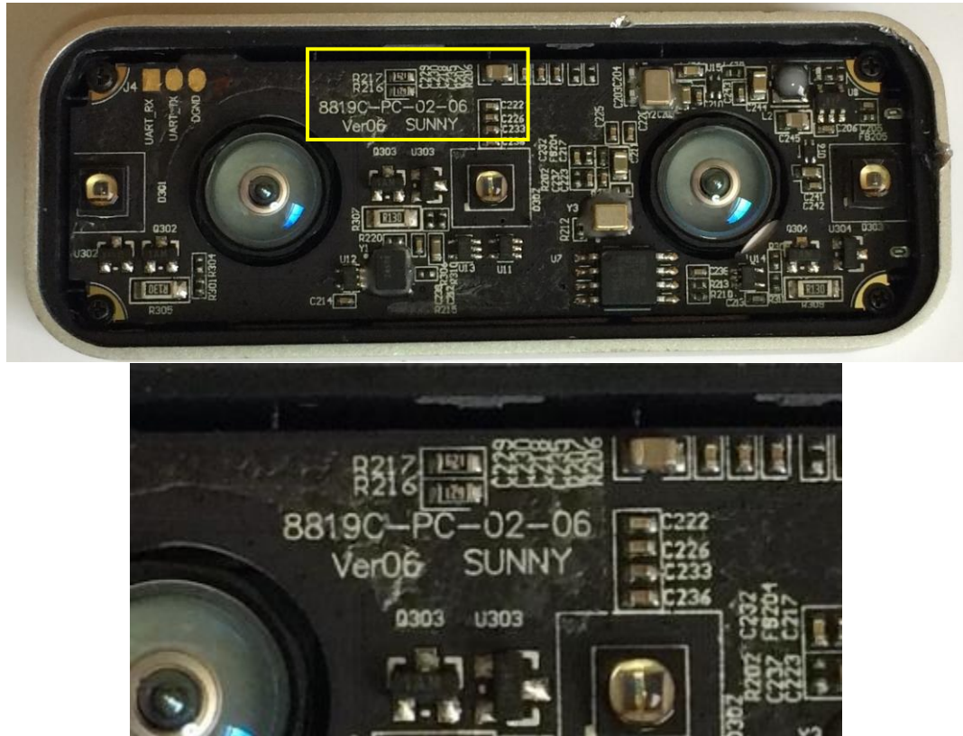
Figura 127. Grabado en PCB que indica la empresa manufacturera del sensor Leap Motion.
