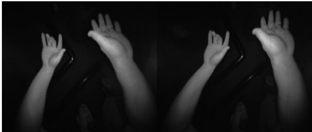
Figura 130. Captura de imagen infrarroja por cámaras del sensor Leap Motion.
