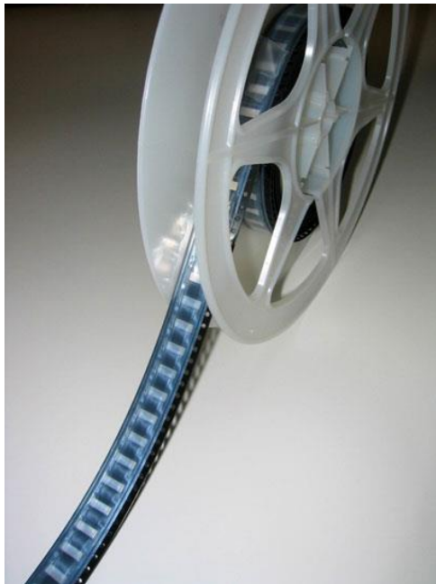
Figura 197. Riel/Carrete de componentes electrónicos.
