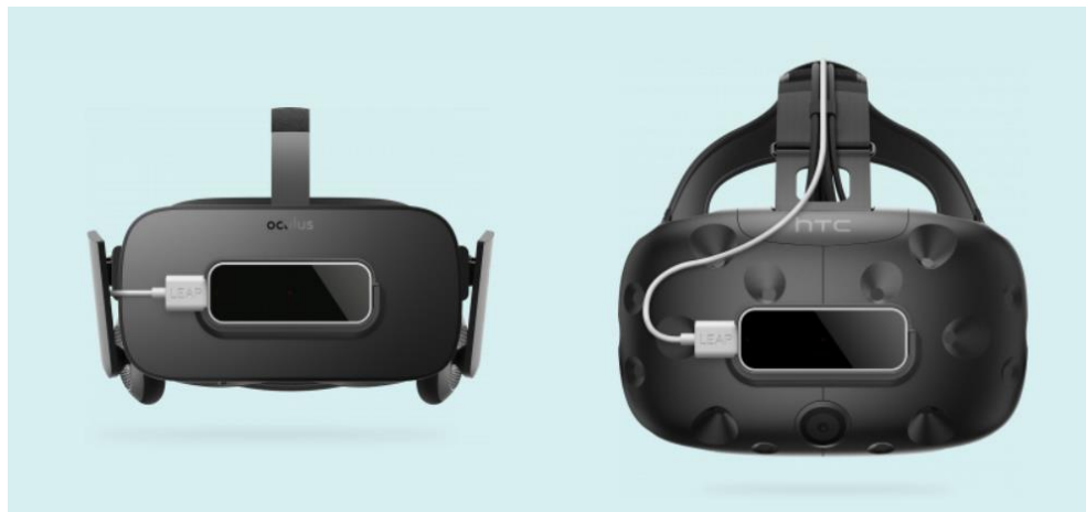
Figura 114. Instalación de un sensor Leap Motion en un HMD.
