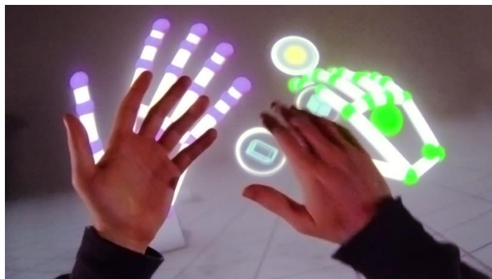
Figura 129. Digitalización de manos realizada por el sensor Leap Motion.
