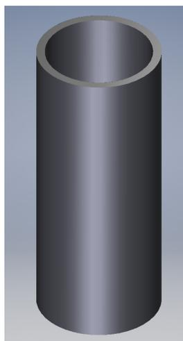
Figura 6.19: Adaptador micrometro-motor.
