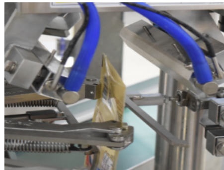
Figura 15: Procedimiento de sellado de bolsas [33].
