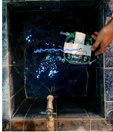
Figura 82: Trayectoria real de BART en movimiento lateral con control de velocidad
