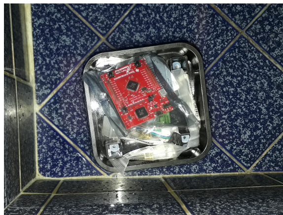
Figura 57: Casco impreso en 3D flotando sobre el agua con peso extra
