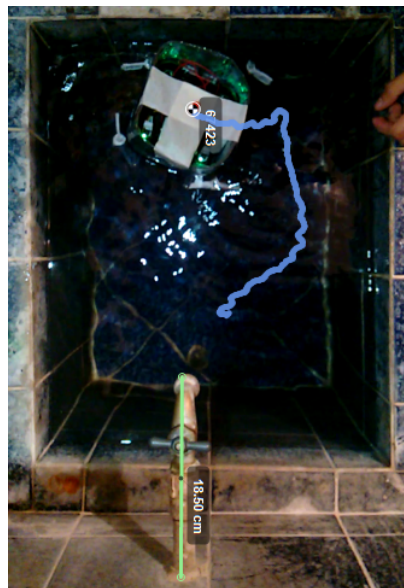
Figura 81: Trayectoria real de BART en movimiento combinado con control de velocidad
