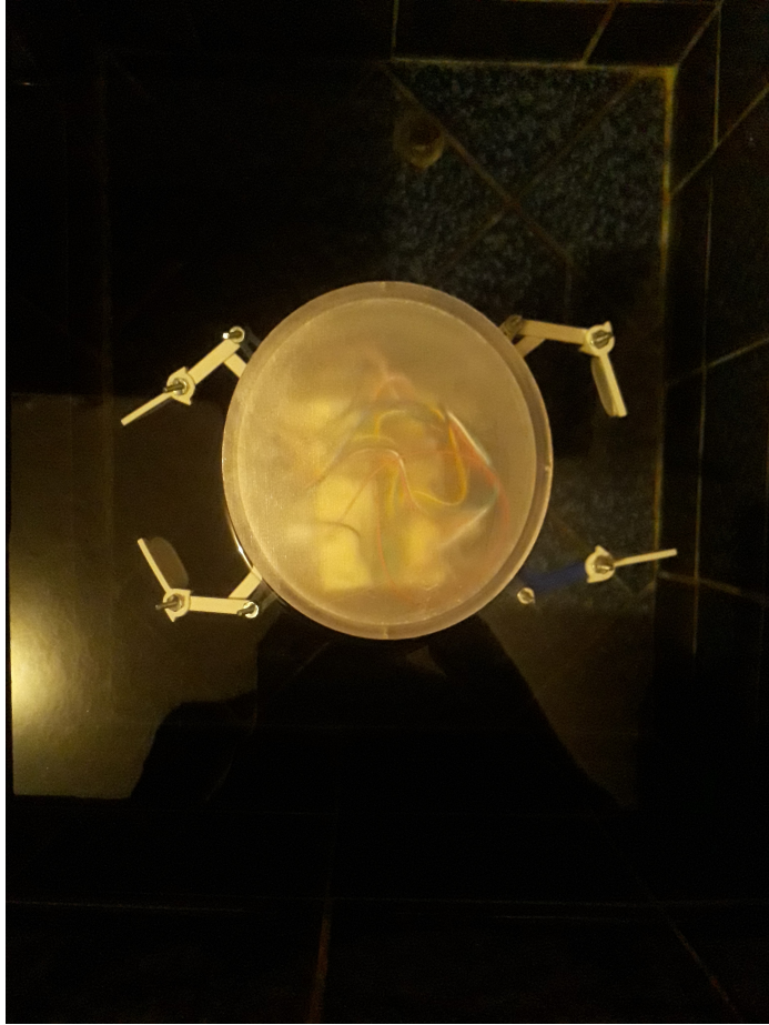
Figura 93: Prototipo final con ensamblaje completo, flotando sobre la superficie del agua
