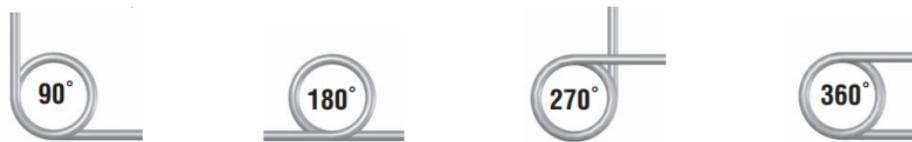
Figura 3: Configuraciones de un resorte de torsión en posición de equilibrio
