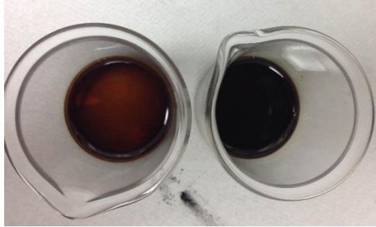
Figura No. 11: Muestras para análisis organoléptico, el beaker a la izquierda contiene el combustible filtrado mientras que el beaker a la derecha contiene el combustible sin filtrar (Laboratorio de Operaciones Unitarias en la Universidad del Valle de Guatemala)
