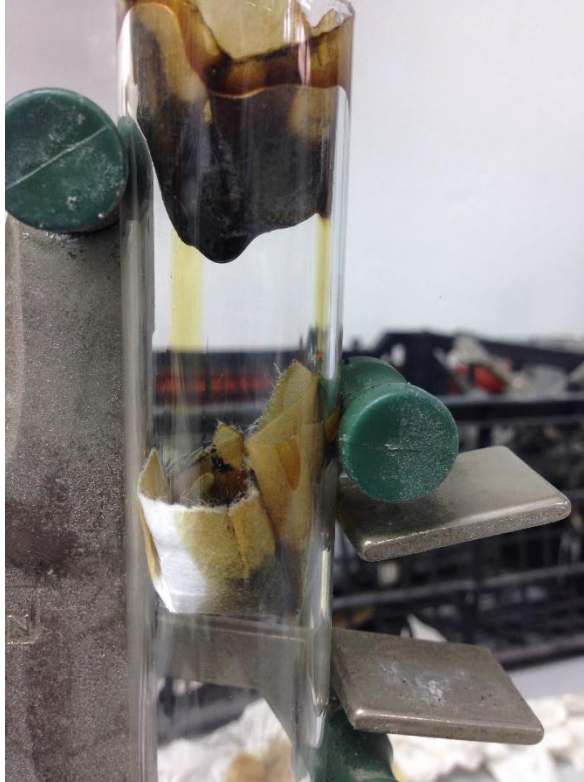
Figura No. 10: Filtración del combustible a través del carbón activado (Laboratorio de Operaciones Unitarias en la Universidad del Valle de Guatemala)
