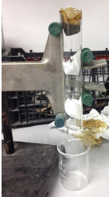
Figura No. 9: Columna de Adsorción a escala laboratorio (Laboratorio de Operaciones Unitarias en la Universidad del Valle de Guatemala)
